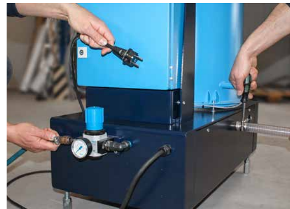
Connections air comprimé, électricité et conduite d'alimentation
